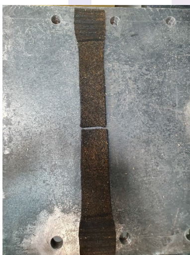
Фото 20. Характер разрушения образцов после воздействия на них смеси песка и масла с концентрацией 5 % в течение 60 суток.
