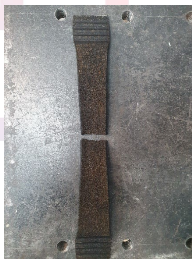
Фото 21. Характер разрушения образцов после воздействия на них смеси песка и масла с концентрацией 5 % в течение 90 суток.
