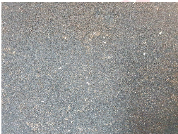
Фото 5. Образец после 60 суток воздействия смеси песка и масла.
