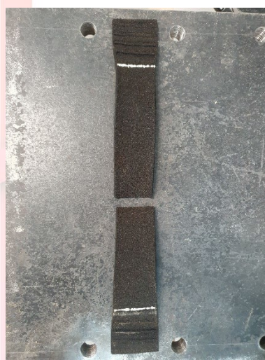
Фото 19. Характер разрушения образцов после воздействия на них смеси песка и масла с концентрацией 5 % в течение 30 суток.
