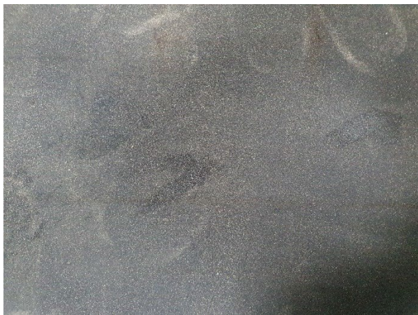
Фото 3. Образец, не подвергнутый воздействию смеси песка и масла.
