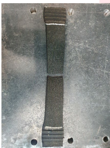
Фото 18. Характер разрушения образцов не подвергнутых смеси песка и масла .
