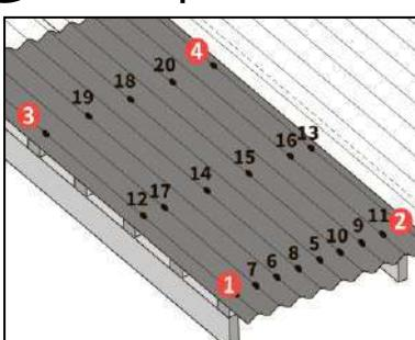
20 гвоздей на лист сначала по углам, потом в каждую волну по нижнему краю листа, потом в шахматном порядке через волну в двух средних линиях. Забивая гвоздь вертикально, в верх волны в нанесённые отметки.
