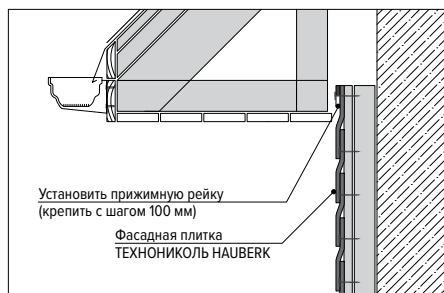
Рис. 9.1. Монтаж верхнего ряда под карнизным свесом. Вариант 1
