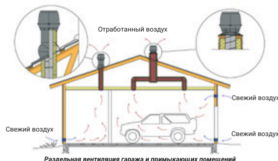
Раздельная вентиляция гаража и примыкающих помещений
